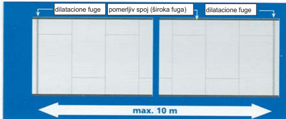
Hodnički plafon sa pomerljivim spojem (širokom fugom) između plafona i zida.
